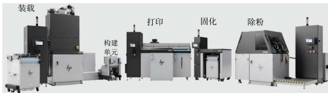
图 11 惠普（Binder Jet）打印系统组成图
