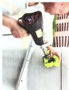
导电胶废气净化塔采样
