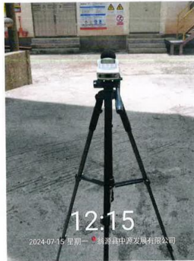
噪声现场检测图
