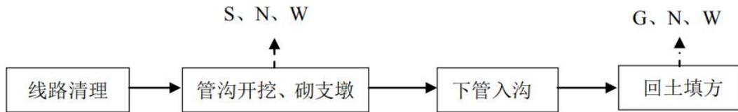
图 5-1 管道施工工艺及产污节点图
